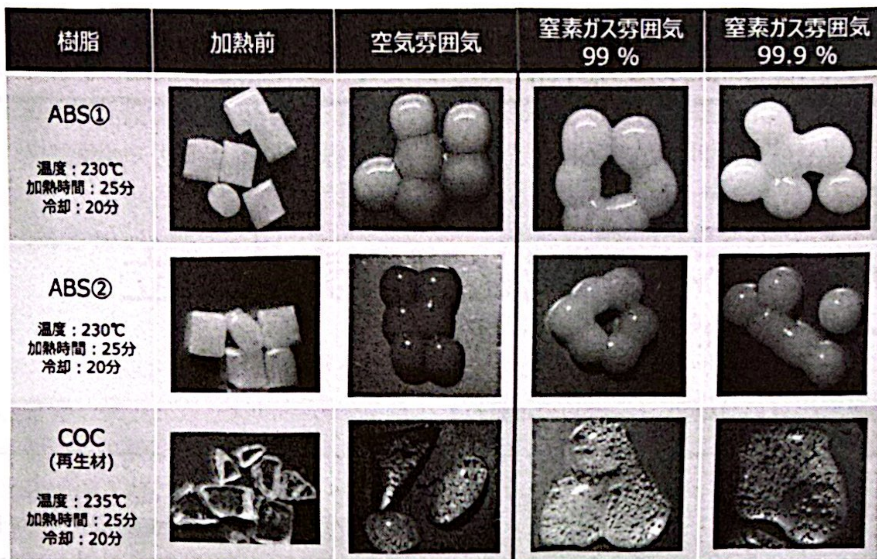
写真2 窒素純度による酸化抑制の比較
